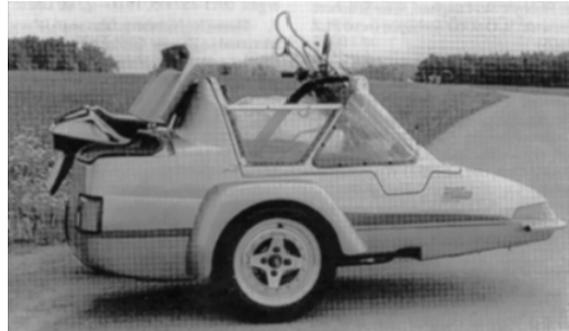
Großer Kofferraum; das Seitenwagenrad wird mitgebremst. Zum Einstieg klappt die gesamte Haube nach vorn.
